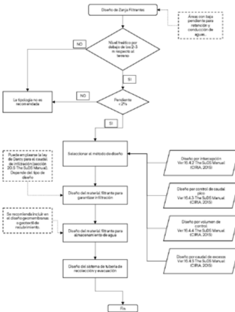
Figura 44. Diagrama para el diseño de Zanjas filtrantes. Fuente. Elaborado a partir del Manual de SuDS (CIRIA Norfolk Country Council, 2015).
