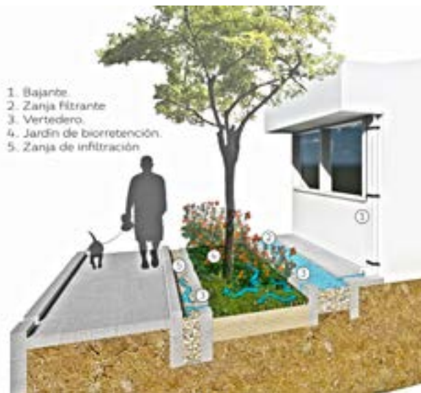
Figura 72. Ejemplo de desconexión de zonas impermeables. Fuente: adaptado de Faha, Faha, & Milligan, 2009.
