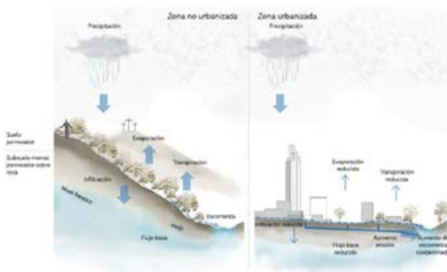
Figura 1. Efectos de la urbanización en el ciclo hidrológico natural. Fuente: Adaptado de Melbourne Water, 2020.
