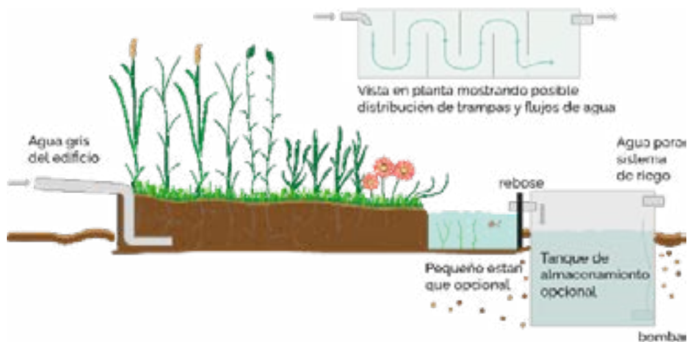
Figura 37. Ejemplo de sistema natural de depuración por cámaras de flotación, depuración y decantación. Fuente: elaboración propia, 2021.
