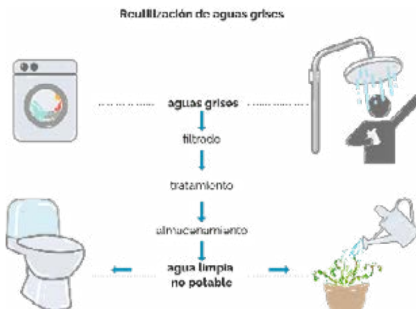
Figura 39. Esquema de reutilización de aguas grises tratadas. Fuente: elaboración propia, 2021.
