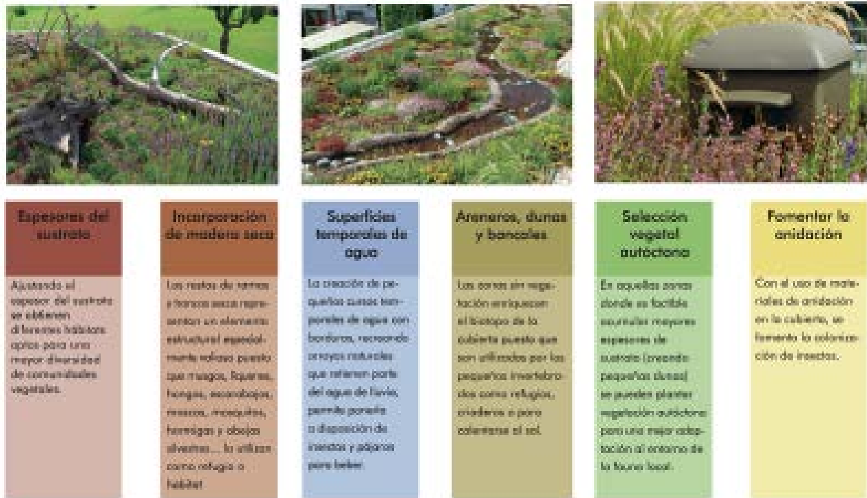
Figura 10. Estrategias de diseño de hábitats en una cubierta biodiversa. Fuente: Cubierta verde 4.0 | Sistemas para cubiertas verdes | ZinCo Green Roof, s. f.
