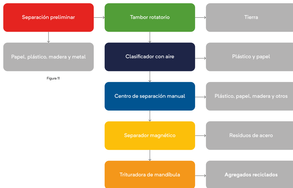
Figura 22. Proceso de separación para la producción de agregados reciclados a partir de RCD. Fuente: Pacheco Torgal F. & Jalali S., 2011.
