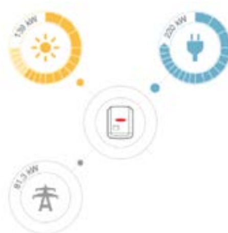
Figura 30. Esquema básico de un sistema solar fotovoltaico de conexión a red. Fuente: FRONIUS.
