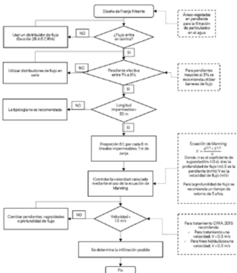
Figura 82. Diagrama para el diseño de Zanjas filtrantes. Fuente: Elaborado a partir del Manual de SuDS (CIRIA Norfolk Country Council, 2015)
