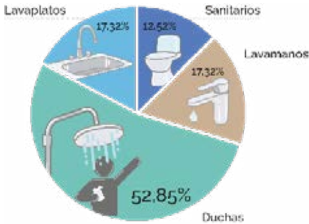
Figura 9. Consumos de agua por aparatos en vivienda VIS en Cali, basado en estudio del programa BEA para Cali, 2019. Fuente: elaboración propia, 2021.
