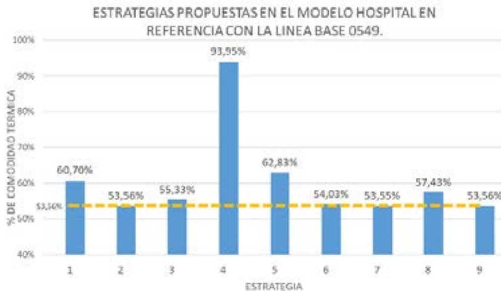
Figura 34. Porcentaje anual de horas en confort térmico con la implementación de las estrategias bioclimáticas versus la línea base del modelo Hospital. Fuente: elaboración propia, 2021.
