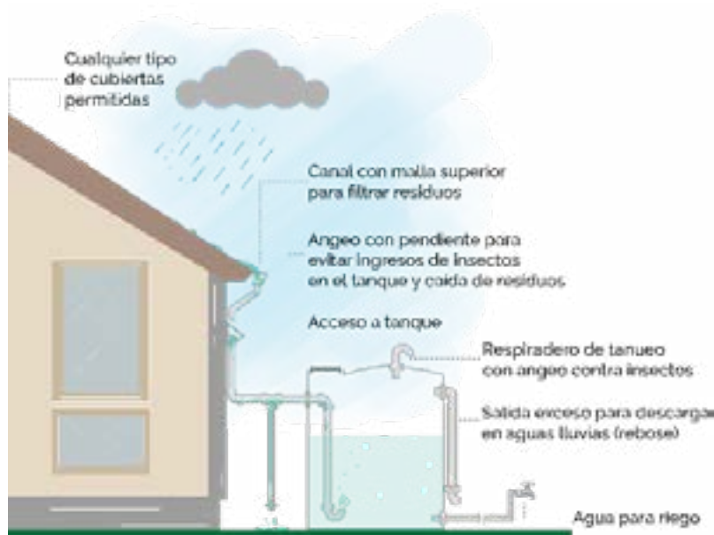
Figura 20. Ejemplo de sistema sencillo de aprovechamiento de aguas lluvias para riego, con almacenamiento de aguas lluvias, malla de filtrado de partículas y mallas para control de insectos Fuente: elaboración propia, 2021.
