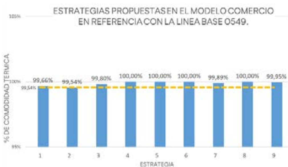
Figura 33. Porcentaje anual de horas en confort térmico con la implementación de las estrategias bioclimáticas versus la línea base del modelo Comercio. Fuente: elaboración propia, 2021.
