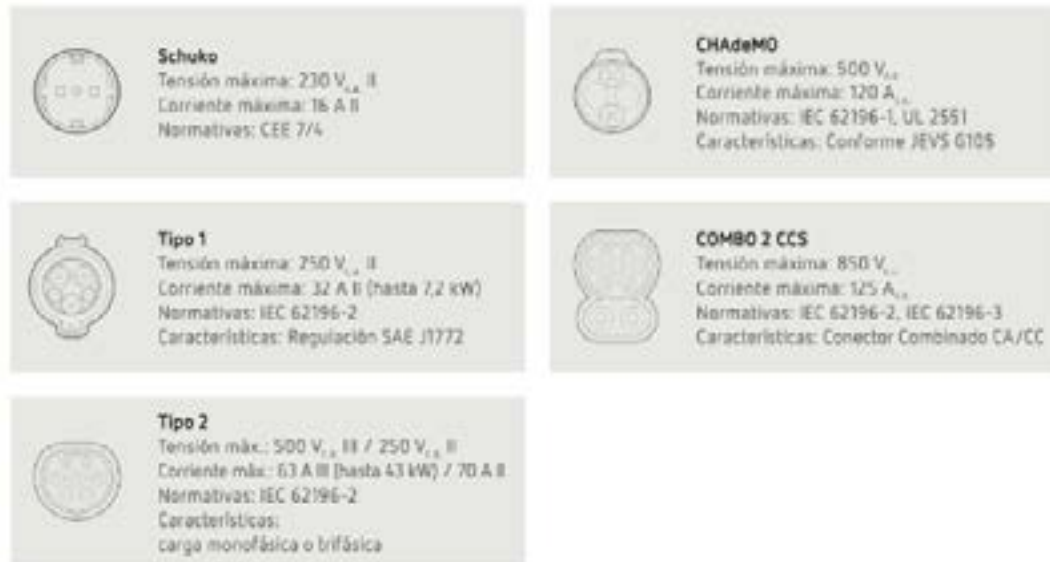
Figura 11. Tipos de conectores en cargadores de vehículos eléctricos. Fuente: Catálogo Movilidad Eléctrica, Equipos y sistemas inteligentes. Circutor.es
