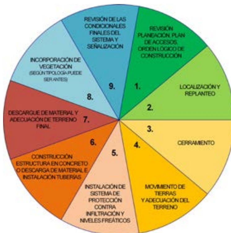
Figura 53. Esquema de etapas de construcción. Fuente: elaboración propia, 2021.
