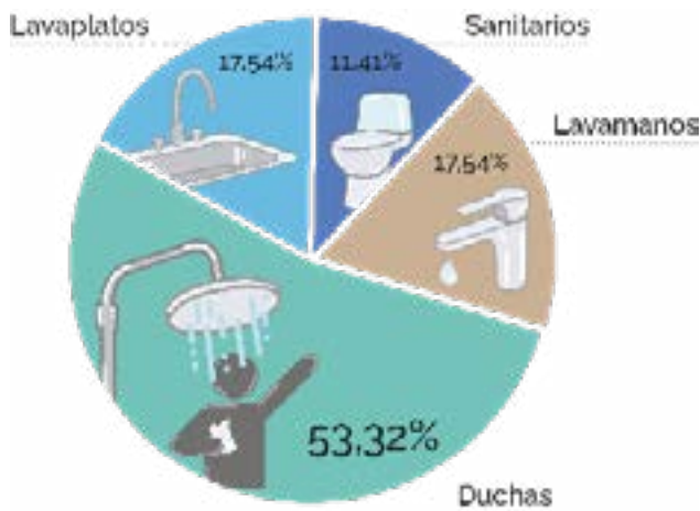
Figura 9. Consumos de agua por aparatos en vivienda VIS en Cali, basado en estudio del programa BEA para Cali, 2019. Fuente: elaboración propia, 2021.
