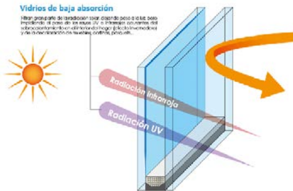
Figura 9. Esquema de funcionamiento de un vidrio de baja absorción. Fuente: tomado de https://aluminiosfiser.com
